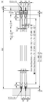
★ Zentrierhilfe für 6mm Glas Centering help for 6mm glass Aide de centrage pour verre 6mm
